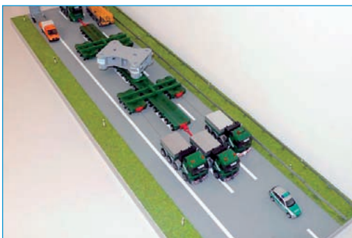
Modellaufbau vom „Krokodil“, Transport mit Rekordmaße: Mit 580 t auf 34 Tiefladerachsen, mit drei Zugmaschinen und einem Schieber.
