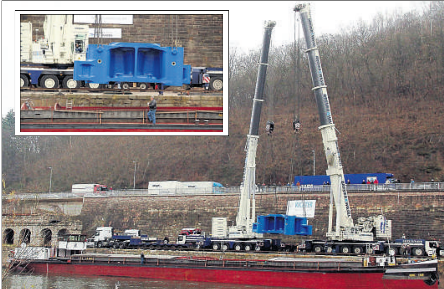
Tonnenschwere Fracht am Haken: Die Kranführer steuern die beiden 500-Tonnen-Kräne und heben das 210 Tonnen schwere Gussteil in den Bauch des Güterschiffes Heide-Luise. In Bremen wird die Fracht weiter auf ein Schiff mit dem Ziel USA verladen. Foto s: Krischmann
